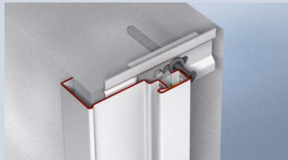
Eckzargen-Profil 1 mit dem Ständerwerk verschrauben
